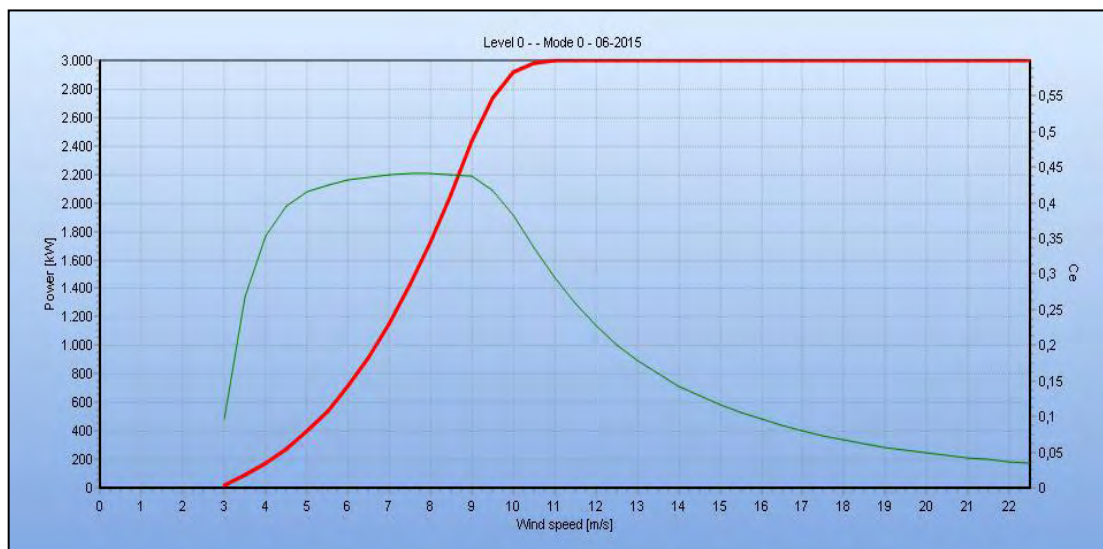
Σχήμα 4.13: Χαρακτηριστική καμπύλη Ισχύος-Βαθμού απόδοσης-ταχύτητας ανέμου ανεμογεννήτριας 3MW
