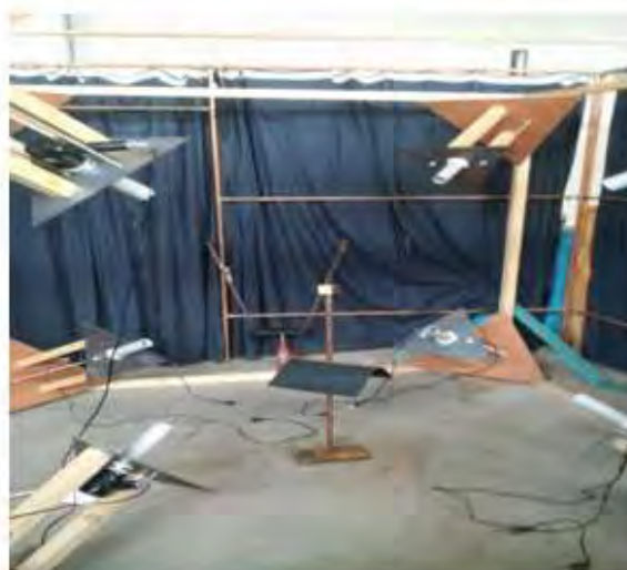
Εικόνα 3.1- Θάλαμος Ισότροπης και Ομογενούς Τύρβης
