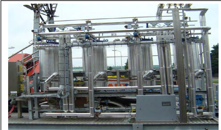
Εικόνα 9: Βιομηχανική μονάδα ενζυμικής ενδοεστεροποίησης με τέσσερις packed-bed αντιδραστήρες συνεχούς ροής, κάθε ένας από τους οποίους περιέχει 25kg ενζύμου. Gibon, V, (2011). Enzymatic interesterification of oils. Lipid Technology , Vol 23, No 12, p. 275.
