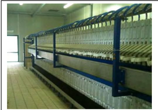
Εικόνα 49: Φιλτράρισμα κρυστάλλων υπό πίεση με τη χρήση διαδοχικών μεμβρανών φύλλου (Εταιρεία Chempro https://www.chempro.in/processes.htm )
