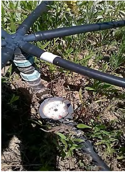
Εικόνα 5.5. Υδρόμετρο (πειραματικός αγρός).
