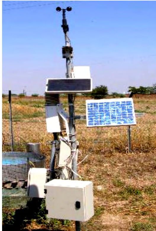
Εικόνα 5.19. Ο αυτόματος μετεωρολογικός σταθμός του Εργαστηρίου Γεωργικής Υδραυλικής.
