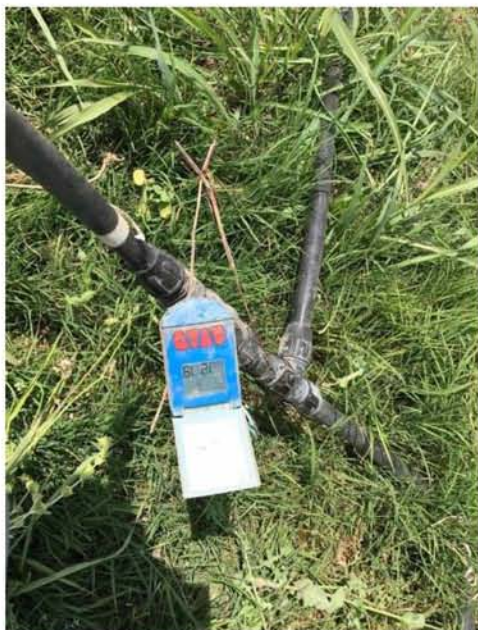
Εικόνες 9 & 10: Προγραμματιστής Άρδευσης και Υδρόμετρο αντίστοιχα στον Πειραματικό αγρό.
