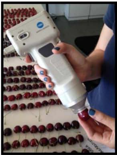
Εικόνα 2.5. Μέτρηση χρώματος φλοιού του κερασιού με τη βοήθεια του χρωματομέτρου.
