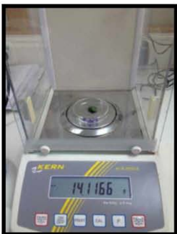
Εικόνα 2.17. Ζύγιση των 12 δίσκων ελάσματος φύλλου σε ζυγό ακριβείας.
