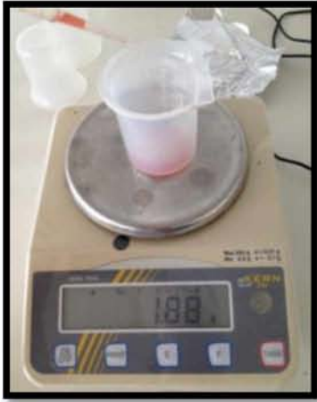
Εικόνα 2.12. Ζύγιση χυμού κερασιών για τιτλοδότηση.
