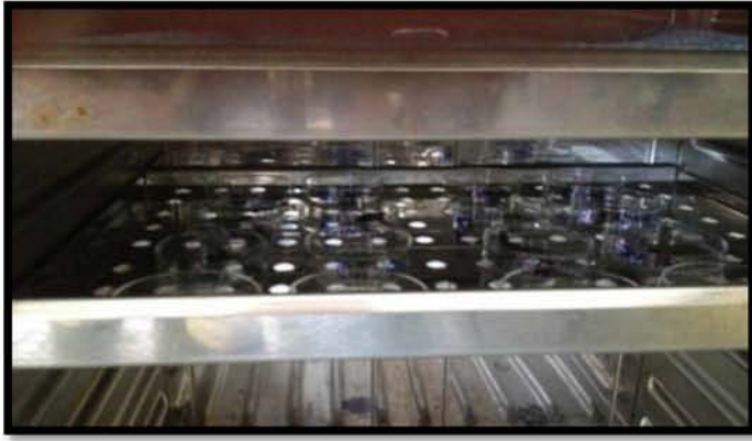
Εικόνα 2.18. Οι ζυγισμένοι δίσκοι ελάσματος φύλλου τοποθετημένοι σε φούρνο στους 80 °C για την ξήρανσή τους.
