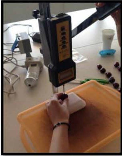
Εικόνα 2.8. Μέτρηση σκληρότητας καρπού με χρήση πιεσίμετρου.
