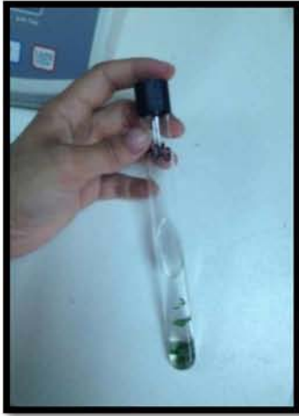
Εικόνα 2.21. Κομματιασμένοι δίσκοι ελάσματος φύλλου τοποθετημένοι σε screw top δοκιμαστικό σωλήνα με 15 mL αιθανόλης 95%.
