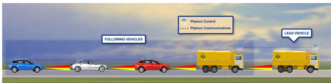
Εικόνα 6.1: Το platooning αφορά μια ομάδα οχημάτων που κινούνται σε πολύ μικρές αποστάσεις μεταξύ τους κάνοντας χρήση της τεχνολογίας της συνδεσιμότητας. [Πηγή]: (Driveless Transportation, 2014)
