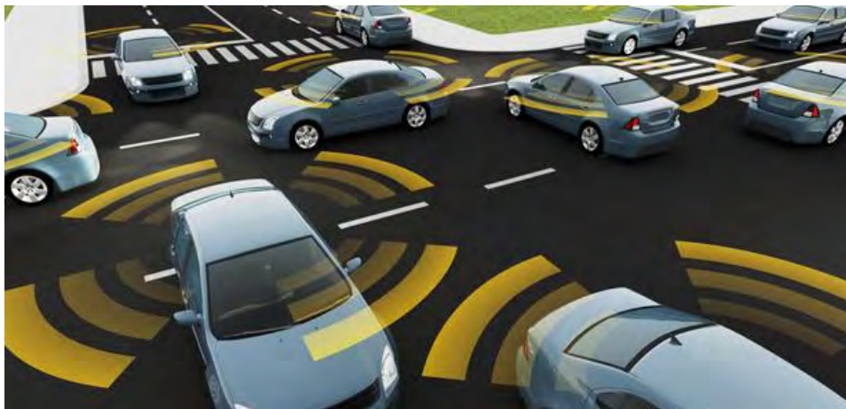
Εικόνα 4.2: Η επικοινωνία V2V επιτρέπει την ανταλλαγή δεδομένων μεταξύ των οχημάτων και παρέχει πληροφορίες στους οδηγούς σχετικά με την πιθανότητα σύγκρουσης. [Πηγή]: (Leonard, 2017)
