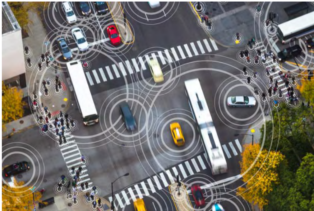
Εικόνα 4.6: Η επικοινωνία V2X αφορά ένα «έξυπνο» σύστημα μεταφοράς στο οποίο ένα όχημα αλληλεπιδρά με οποιαδήποτε οδική οντότητα [Πηγή]: (Laird, 2015)
