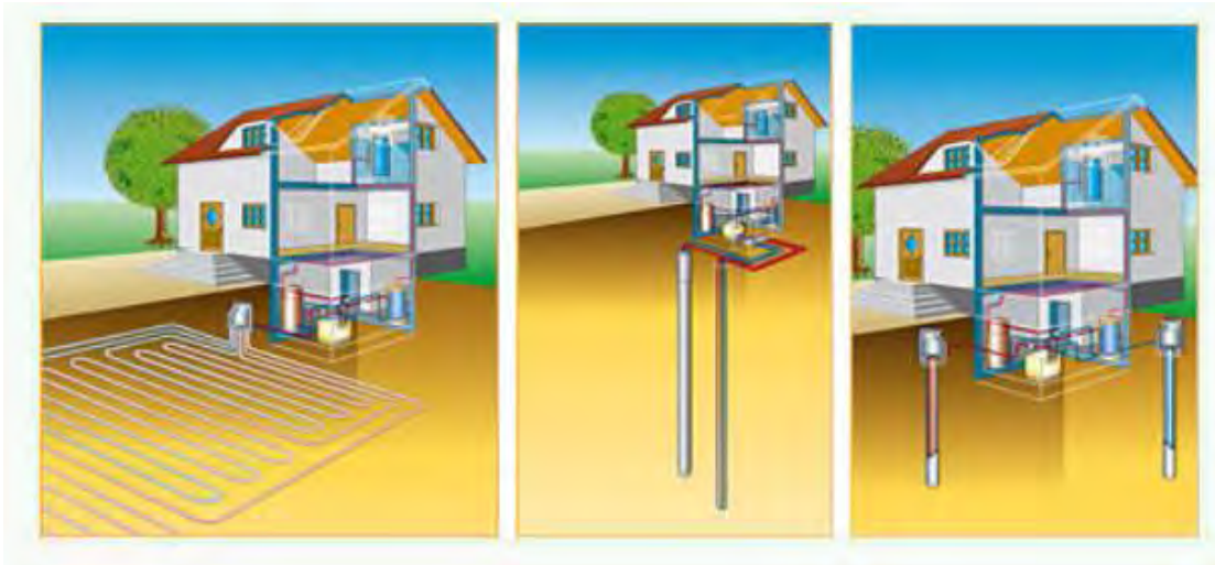
Εικόνα 2.16 Συστήματα κλειστού και ανοιχτού κυκλώματος Πηγή: ( http://www.geoergo.gr/geothermia.html )
