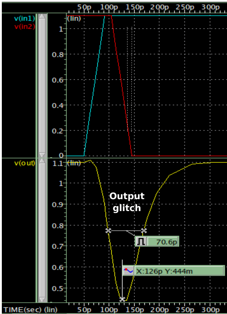
Εικόνα 4.7: Απόσταση μεταξύ των χρονικών στιγμών όπου κάθε μια από τις δύο μεταβάσεις στις εισόδους είναι στο 50% της τάσης τροφοδοσίας = 0,05464507 ns
