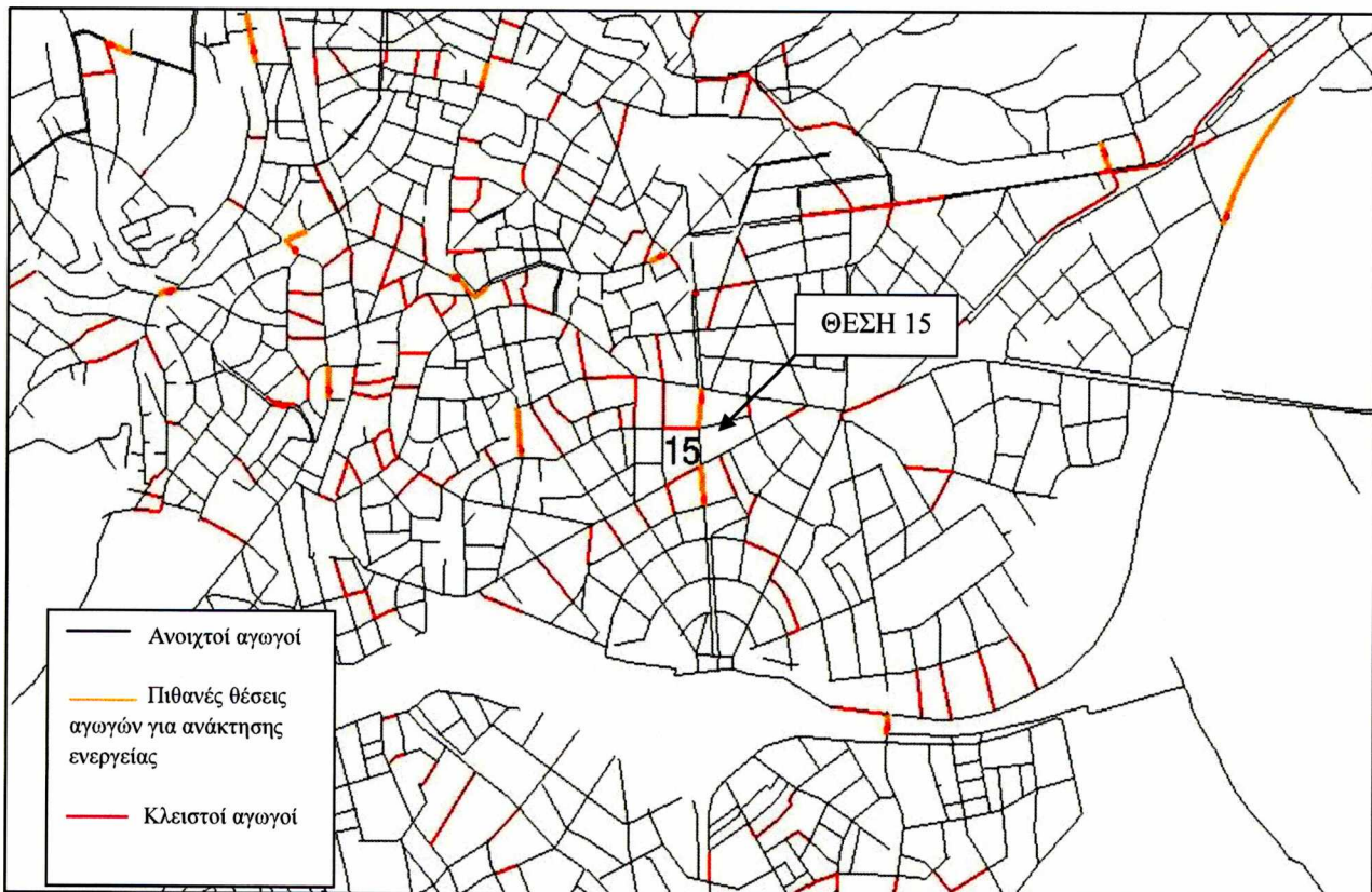
Εικόνα 3.15: Σημείο 15 πιθανή θέση ανάκτησης ενέργειας
