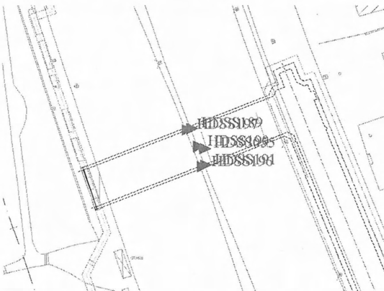
Σχήμα 30: Σημεία in situ μέτρησης καθιζήσεων από ΑΤΤΙΚΟ ΜΕΤΡΟ Α.Ε.
