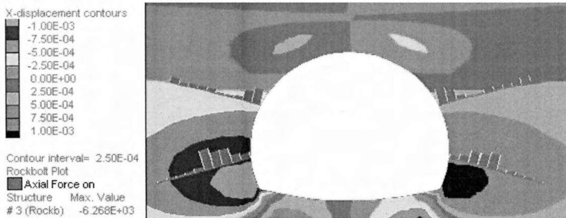
Σχήμα 18: Αξονικές Δυνάμεις Ηλώσεων Βράχου μετά την εκσκαφή και προσωρινή υποστήριξη της σήραγγας. (FLAC7)
