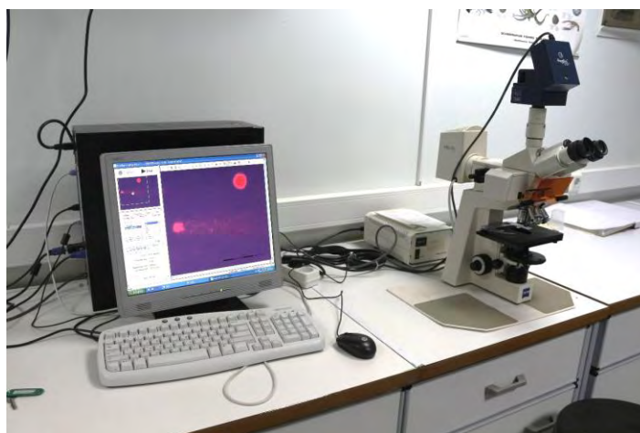
Εικόνα 9. Ηλεκτρονικά συστήματα καταγραφής κομητών
