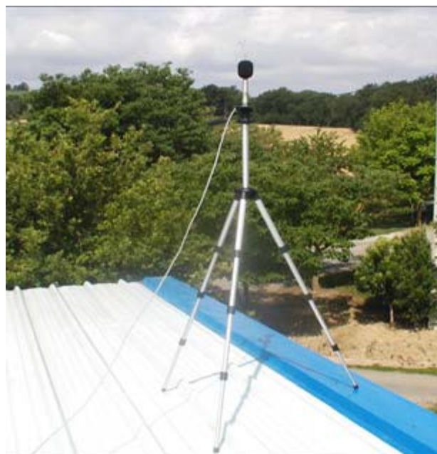
Σχήμα 4-15: Διάταξη παντός καιρού BAP 21 Πηγή: Σ.Σ.Ε& Περιβάλλον Α.Ε
