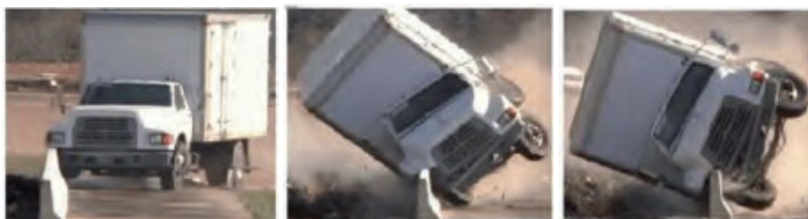
Σχήμα 4-6: Απεικόνιση οχημάτων να υπερπηδούν στηθαίο ασφαλείας σκυροδέματος σε περίπτωση πρόσκρουσης. Πηγή: Noise Transport Agency, 2012
