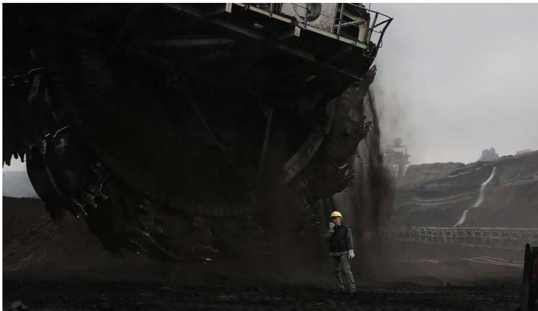
Εικόνα 9: Εξόρυξη λιγνίτη με καδοφόρο εκσκαφέα στο "Νότιο πεδίο" Πτολεμαΐδας (πηγή: http://www.naftemporiki.gr/slideshows/871903/to-mauro-topio-ton-lignitoruxeion/all )
