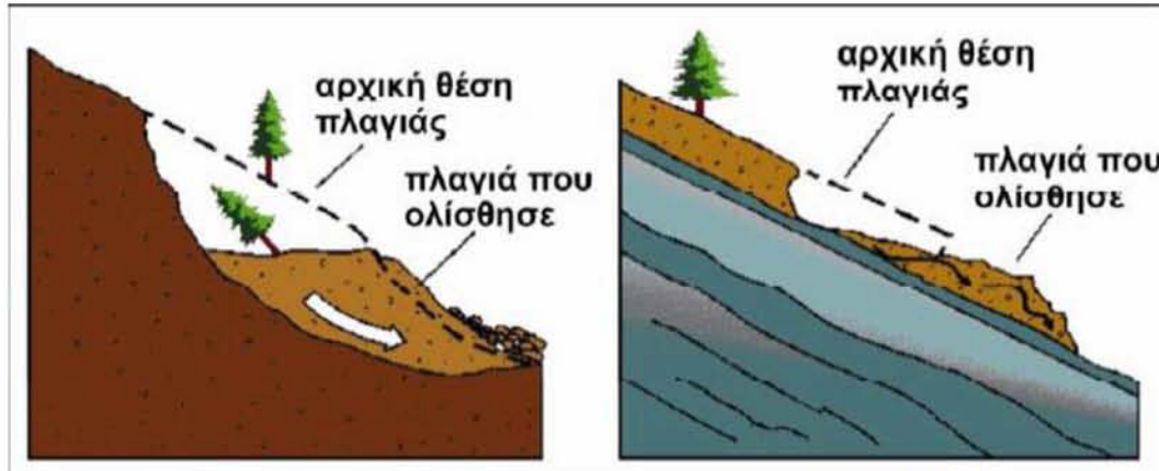
Εικόνα 4.2- Κατολίσθηση πλαγιάς λόγω σεισμού ( www.google.gr )
