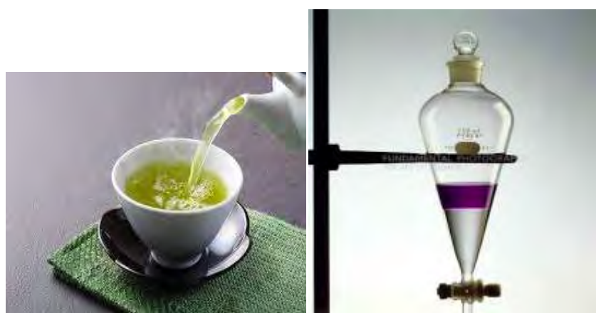
ΕΙΚΟΝΑ 3.4 Απλή εκχύλιση ενός αφεψήματος (αριστερή εικ.) και η εκχύλιση στο εργαστήριο με διαχωριστική χωάνη (δεξιά εικ.)
