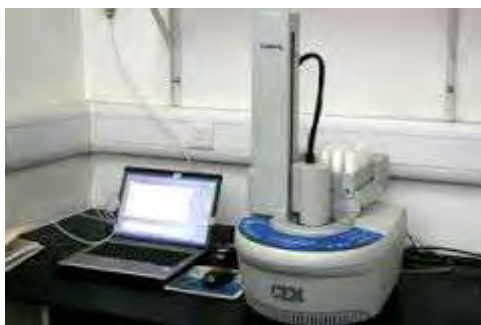
ΕΙΚΟΝΑ 3.1 CEM Microwave. Αντιδραστήρας με αυτόματο συλλέκτη δειγμάτων
