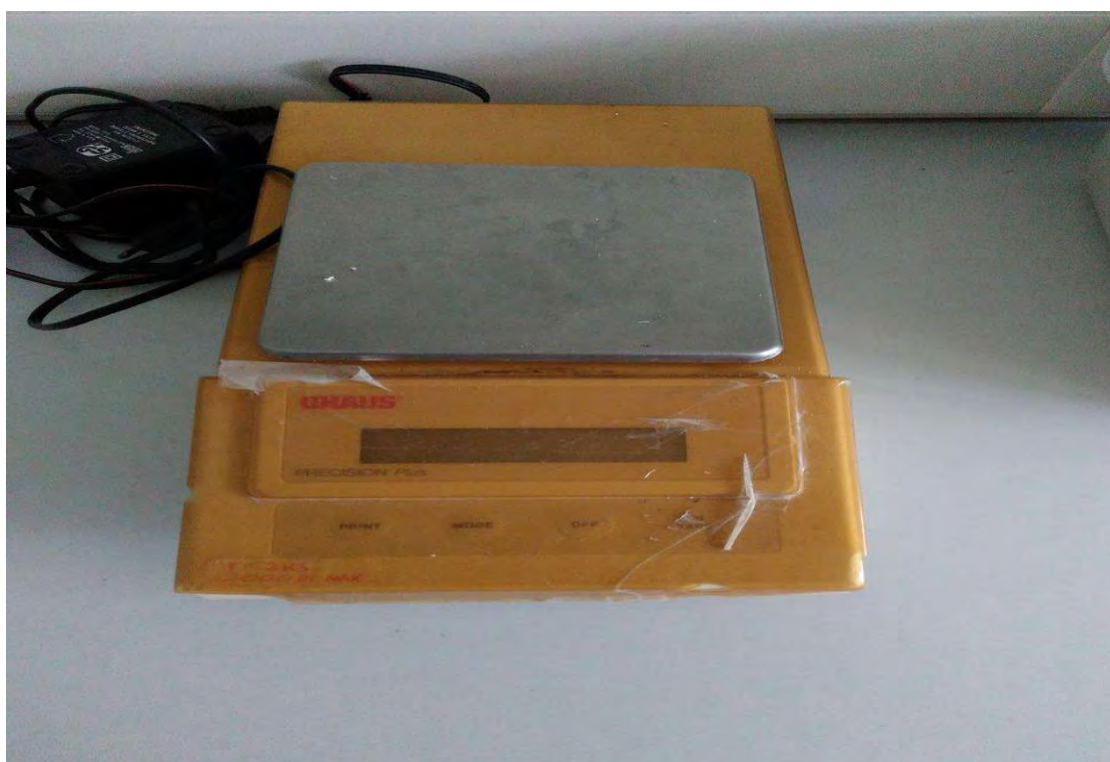
Εικόνα4. Ζυγός μετρήσεων στο εργαστήριο (OHAUS ακρίβειας 0,001 g) (Πηγή: Προσωπικό αρχείο)
