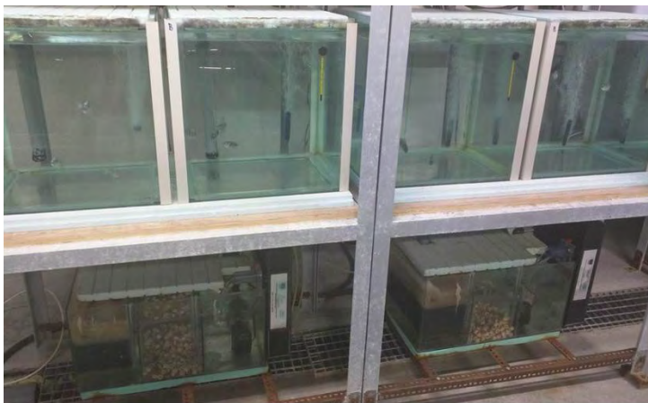
Εικόνα 5. Διάταξη δεξαμενών και απεικόνιση του συστήματος φιλτραρίσματος-αποστείρωσης (φωτογραφία συγγραφέα).
