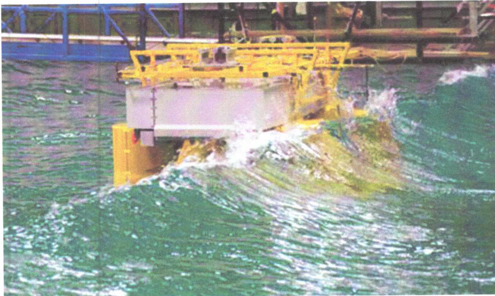
Εικόνα 3.5: Wave slamming οριζόντιο στις κολώνες και κατακόρυφο στο κατάστρωμα.
