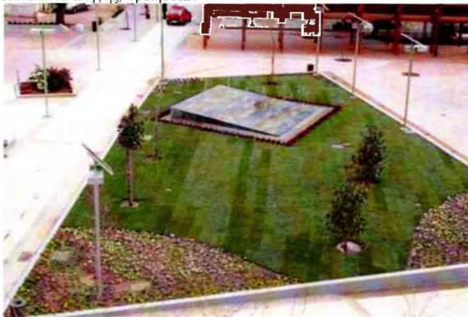
Εικόνα 12: Χώροι πρασίνου και αυτόνομα φωτιστικά σώματα με φωτοβολταϊκά πάνελ στην Πλατεία Ανάληψης, Βριλησίων
