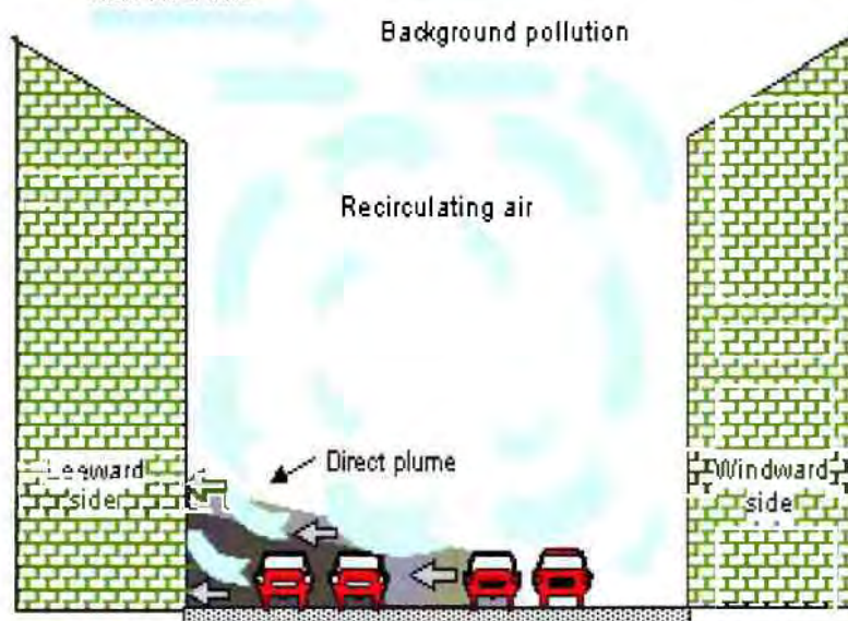
Σχήμα 2: Το φαινόμενο της 'αστικής χαράδρας' Roof level wind
