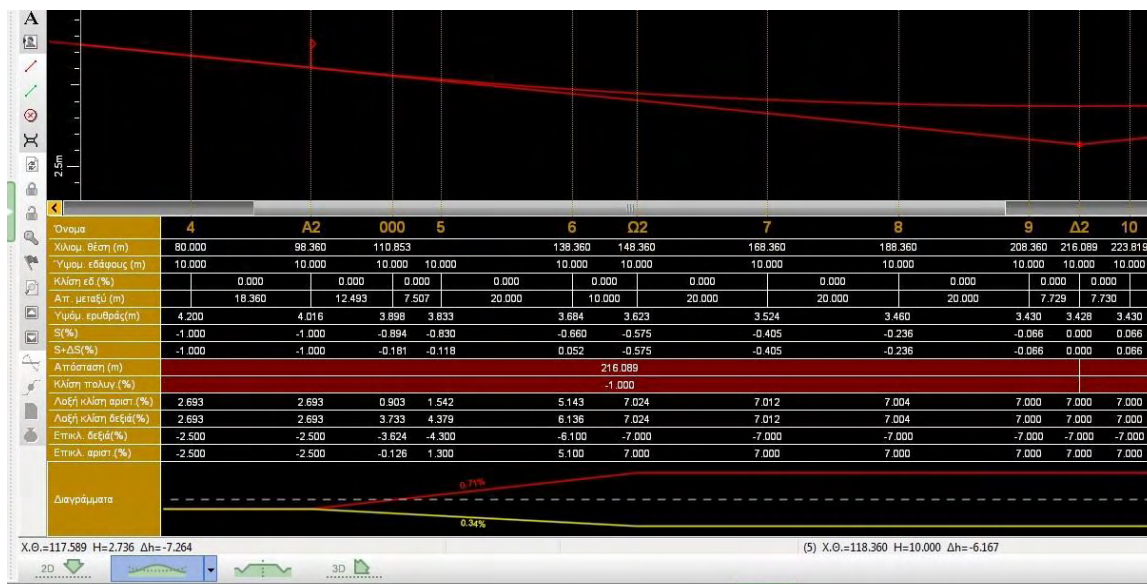
Σχήμα 4-6: Τμήμα ερυθράς με διάγραμμα επικλίσεων και αναγραφή των σχετικών μεγεθών ανά διατομή (Anadelta Tessera)
