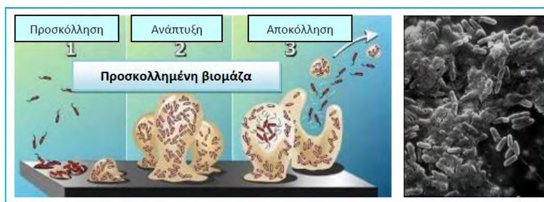
Σχήμα 5.4.4.1. Αερόβια βιολογική επεξεργασία (προσκολλημένη βιομάζα)
