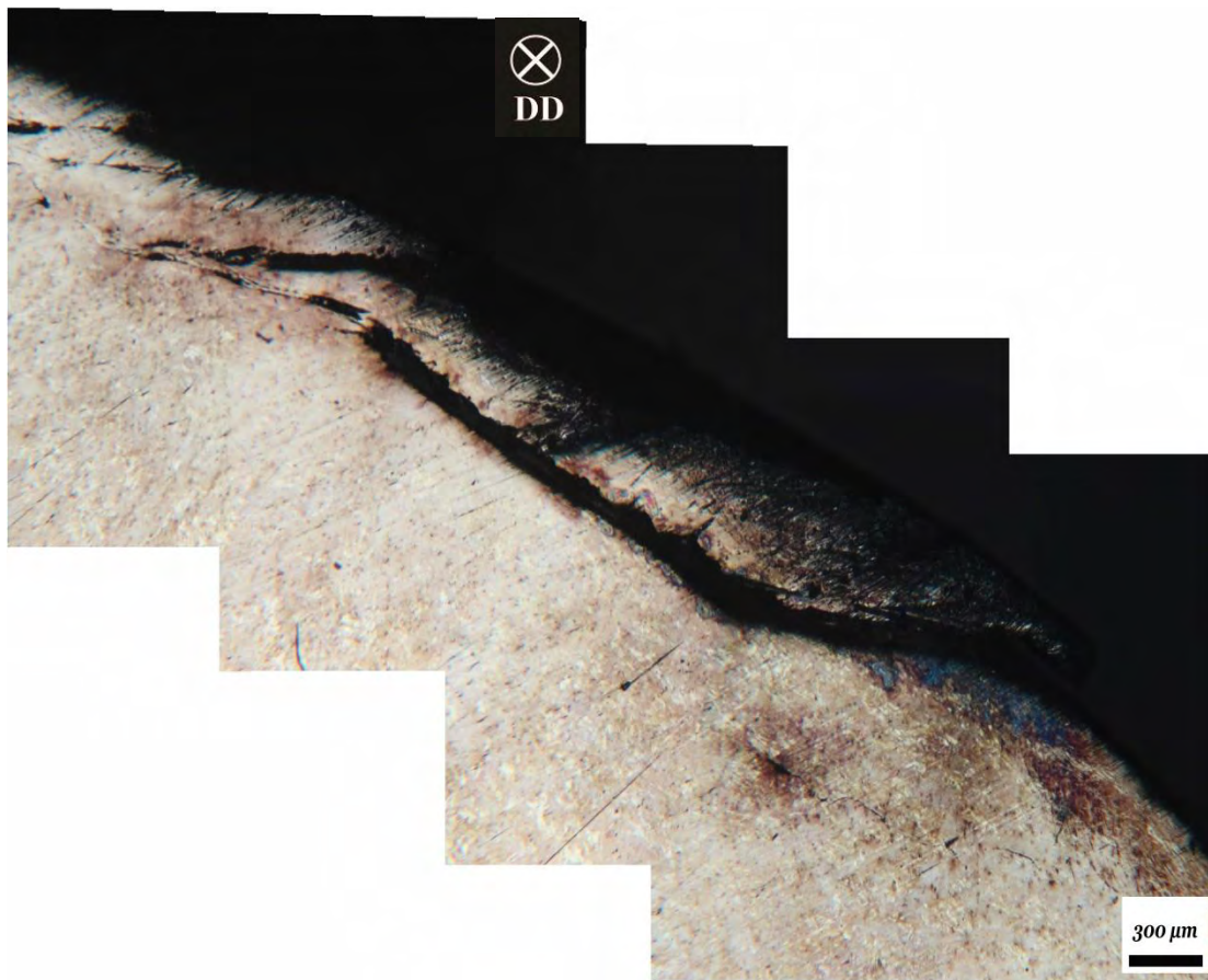
Εικόνα 5.2.16: Εικόνα της αποφλοίωσης στην περιοχή του gauge corner
