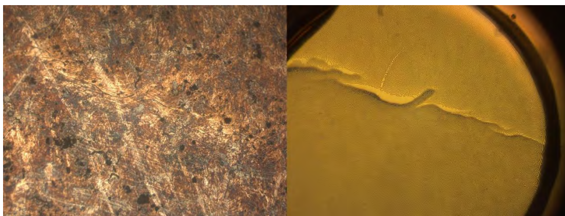
Εικόνα 5.3.4: Ρωγμή στην επιφάνεια του δοκιμίου. Εικόνα από το πολωτικό μικροσκόπιο χωρίς την παρεμβολή του αισθητήρα (αριστερά) και με την παρεμβολή (δεξιά)
