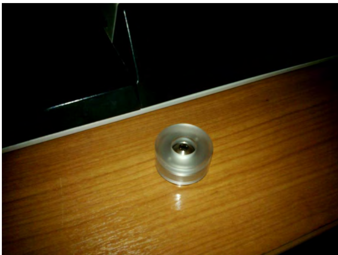
Εικόνα 4.4.1: Ο μαγνητοοπτικός αισθητήρας της εταιρίας MATESY που χρησιμοποιήθηκε στην ανίχνευση των ρωγμών
