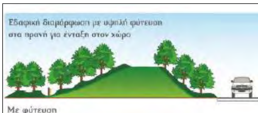
Εικόνα 18. Σχηματική απεικόνιση αντιθορυβικού αναχώματος με φύτευση
