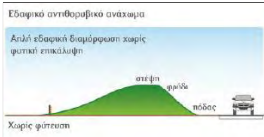
Εικόνα 17. Σχηματική απεικόνιση αντιθορυβικού αναχώματος
