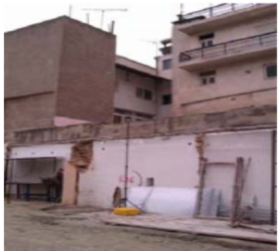
ΕΙΚΟΝΑ 22 Εργοτάξιο «ΜΑΝΙΑΤΙΚΑ»- ΑΥΤΟΝΟΜΟΣ ΚΙΝΗΤΟΣ ΣΤΑΘΜΟΣ ΘΟΥΡΥΒΟΥ ΜΕ ΣΤΑΤΙΣΤΙΚΟ ΑΝΑΛΥΤΗ ΚΑΙ ΔΙΑΤΑΞΗ ΠΑΝΤΟΣ ΚΑΙΡΟΥ (ΣΕ ΕΙΔΙΚΟ ΙΣΤΟ) ΤΥΠΟΥ
