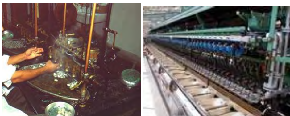
Εικόνες 27 & 28. Αριστερά η αναπήνιση κουκουλιών σε παλαιού τύπου αναπηνιστήριο και δεξιά η αναπήνιση κουκουλιών σε σύγχρονο αναπηνιστήριο (Πηγή: Χαριζάνης Π. & Τζιτζινάκης Μ., Εγχειρίδιο Σηροτροφίας, 2011).
