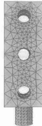
Εικόνα 52: Πλέγμα κοχλιωτού εξαρτήματος με χρήση τετραεδρικών στοιχείων (C3D4).
