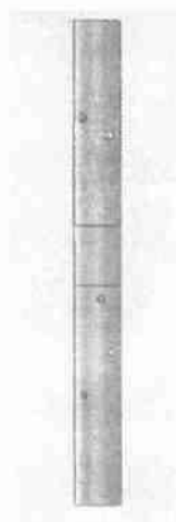
Εικόνα 47: Γεωμετρία κνημιαίου οστού. Διάμετρος 30mm, οπές διαμέτρου 1.8mm, 6mm, 5mm.
