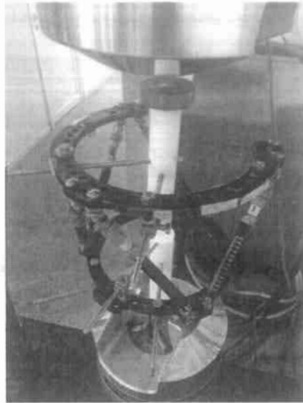
Εικόνα 69: Παραμορφωμένη κατάσταση πειραματικής διάταξης TSF. Από την διάταξη έχει αφαιρεθεί ένα wire διαμέτρου 1.8mm.
