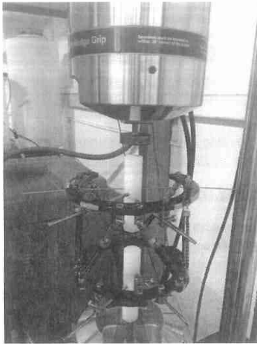
Εικόνα 64: Πειραματική διάταξη πλαισίου TFS. Από την πειραματική διάταξη έχει αφαιρεθεί ένα half pin διαμέτρου 5mm.
