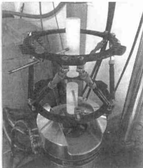
Εικόνα 77: Διάταξη πλαισίου TSF (TSF_1 στο Διάγραμμα 15). Διάμετρος δακτυλίων 180mm (κλειστού τύπου), 2 half rings διαμέτρου 6mm.
