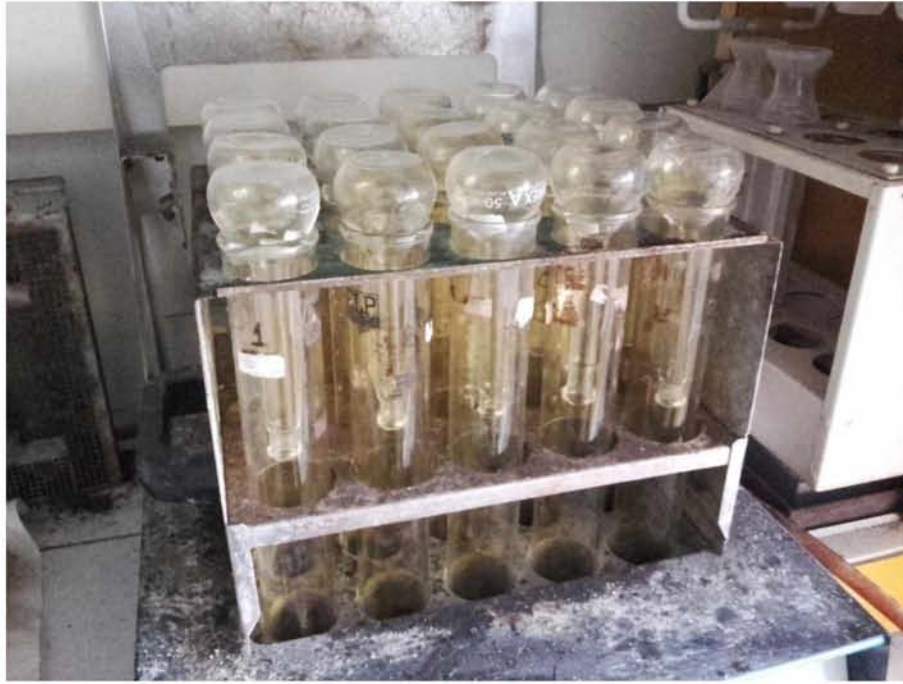
Εικόνα 21. Πυρίμαχες φιάλες για την εκχύλιση με τη μέθοδο Aqua Regia.
