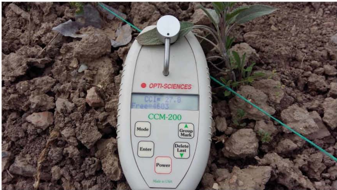
Εικόνα 8. Μέτρηση χλωροφύλλης με την συσκευή Chlorophyll Content Measure (CCM-200) σε φύλλο φασκόμηλου σε συνθήκες αγρού. Η περιεκτικότητα σε χλωροφύλλη φαίνεται από την τιμή CCI της οθόνης.
