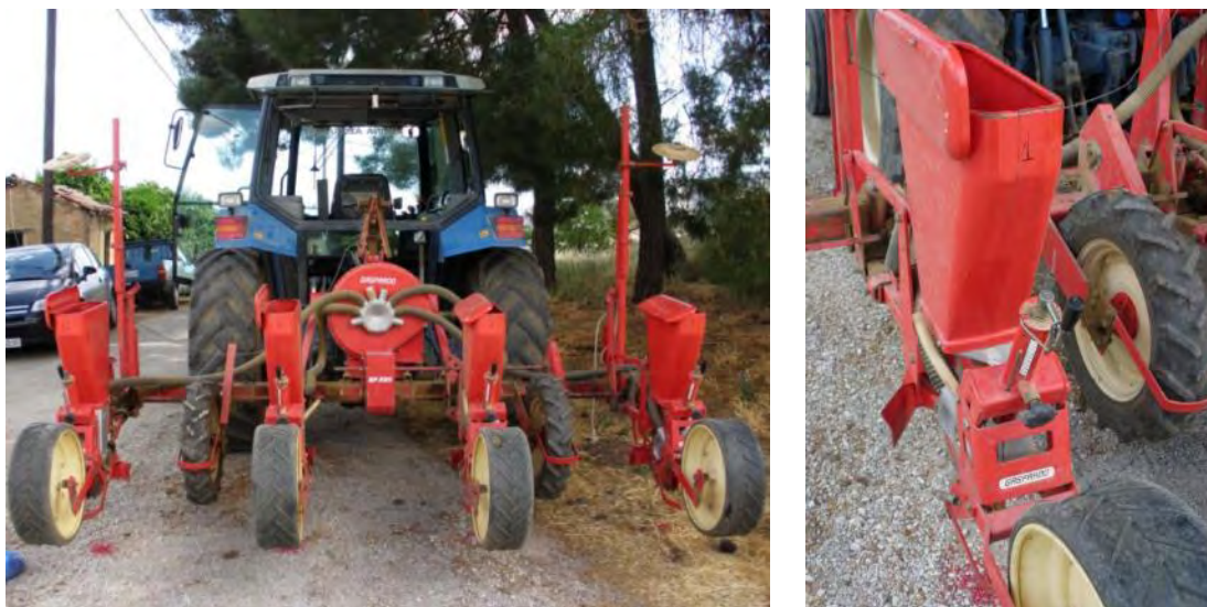
Εικόνα 5.3. Η πνευματική σπαρτική μηχανή.
