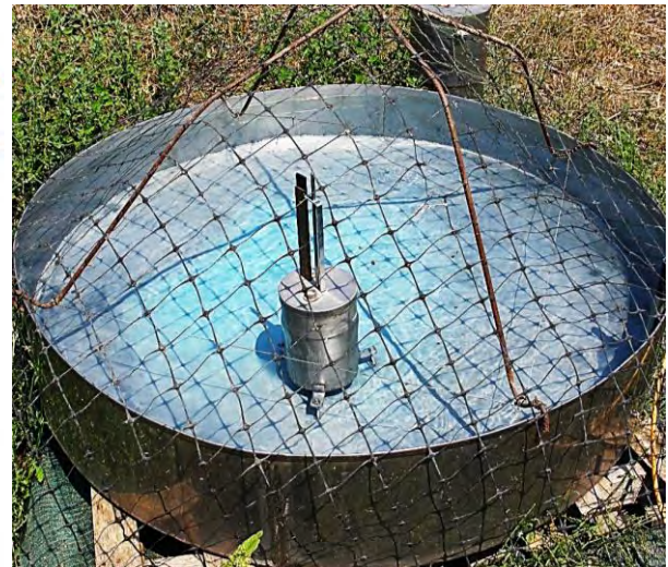
Εικόνα 5.18. Απλό εξατμισόμετρο τύπου Α εγκατεστημένο στον πειραματικό αγρό.
