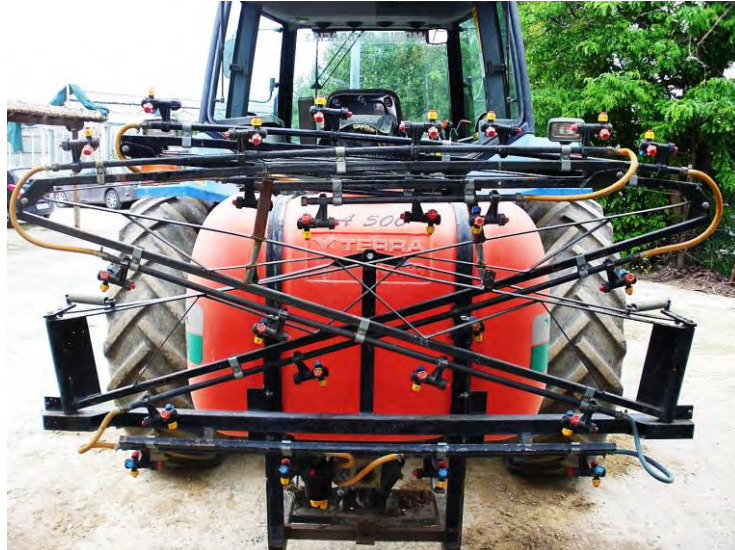
Εικόνα 5.4. Το ψεκαστικό μηχάνημα με το οποίο πραγματοποιήθηκαν οι ζιζανιοκτονίες.
