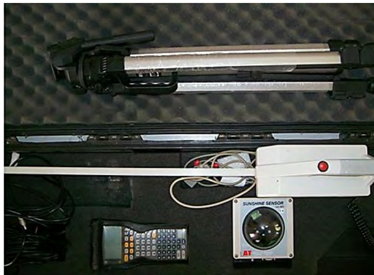
Εικόνα 5.13. Το σύστημα SunScan Canopy Analysis System.
