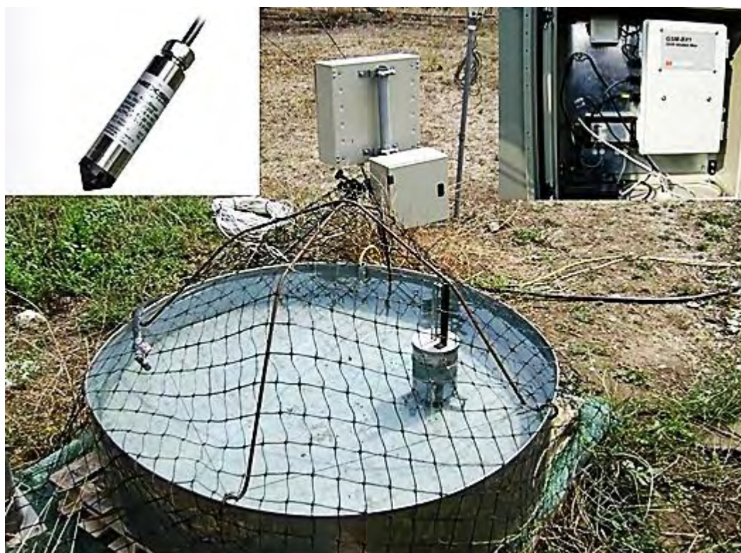
Εικόνα 5.18. Ο αισθητήρας μέτρησης στάθμης νερού του εξατμισιμέτρου WL1, το εξατμισόμετρο τύπου A και ο data logger.
