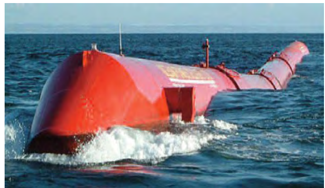
Εικόνα 4.10β Πλωτός σταθμός παραγωγής
