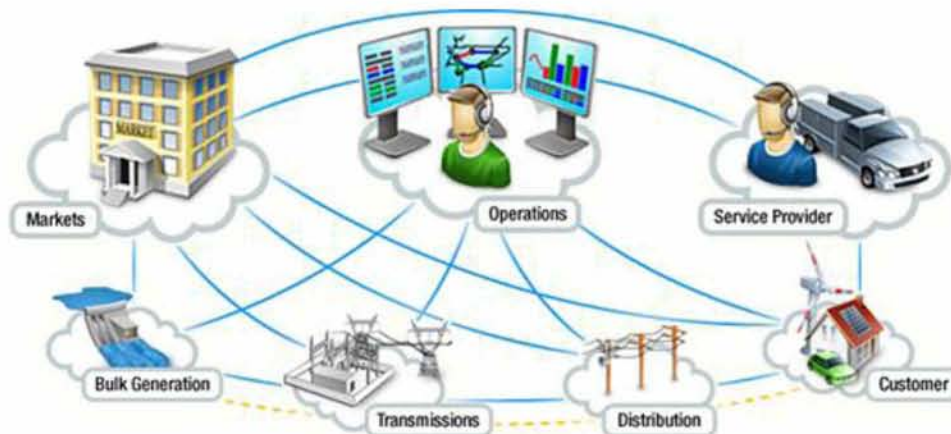
Σχήμα 2.2 : Αρχιτεκτονική ενός Smart Grid[8]
