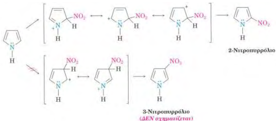
Εικόνα 1.2: ηλεκτρονιόφιλη νίτρωση πυρρολίου
