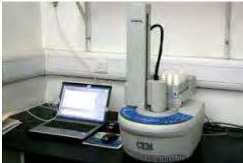
Εικόνα 4.1 CEM Microwave Αντιδραστήρας με αυτόματο συλλέκτη δειγμάτων
