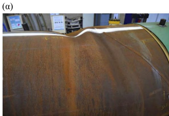
Εικόνα 2.23 Τοπικός λυγισμός του σωλήνα T7 ( D/t = 65,4 ). Ο λυγισμός ξεκίνησε αρχικά μακριά από την ελικοειδή συγκόλληση, αλλά υπό περαιτέρω παραμόρφωση, ο λυγισμός εκτείνεται πέρα από αυτήν. (α) Φωτογραφία λυγισμού, (b) 3D σάρωση λυγισμού.
