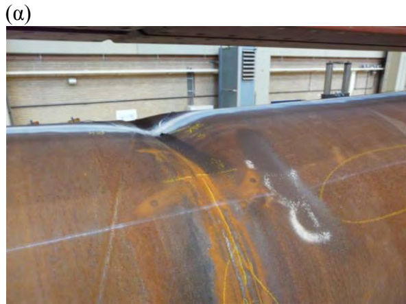
Εικόνα 2.22 Τοπικός λυγισμός του σωλήνα T3 ( D/t = 118 ) κοντά στην περιφερειακή συγκόλληση, (α) Φωτογραφία λυγισμού, (b) 3D σάρωση του λυγισμού
