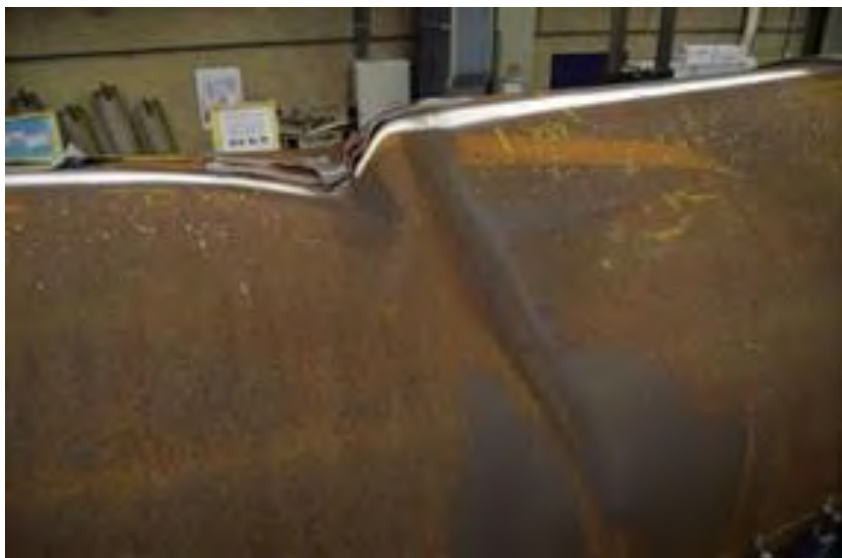
Εικόνα 1.3 Παραμόρφωση που προκαλείται σε σωλήνα που αστόχησε λόγω τοπικού λυγισμού.
