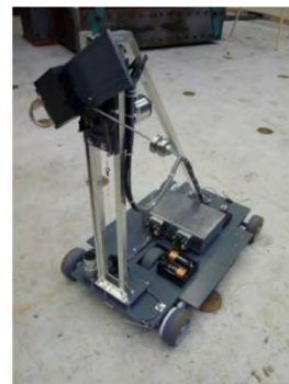
Εικόνα 2.5 Επισκόπηση της σάρωσης με λέιζερ κατά τη διάρκεια της δοκιμής, (α) Σχηματική επισκόπηση της σάρωσης με λέιζερ κατά τη διάρκεια του πειράματος, (β) Αναρτημένες σιδηροτροχιές με εξωτερικό τρόλεϊ λέιζερ, (γ) Εσωτερικό τρόλεϊ λέιζερ.
