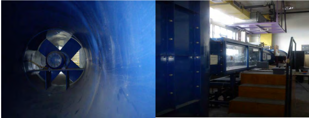
Σχήμα 3.1 Ανεμιστήρας αεροσήραγγας και η αεροσήραγγα
