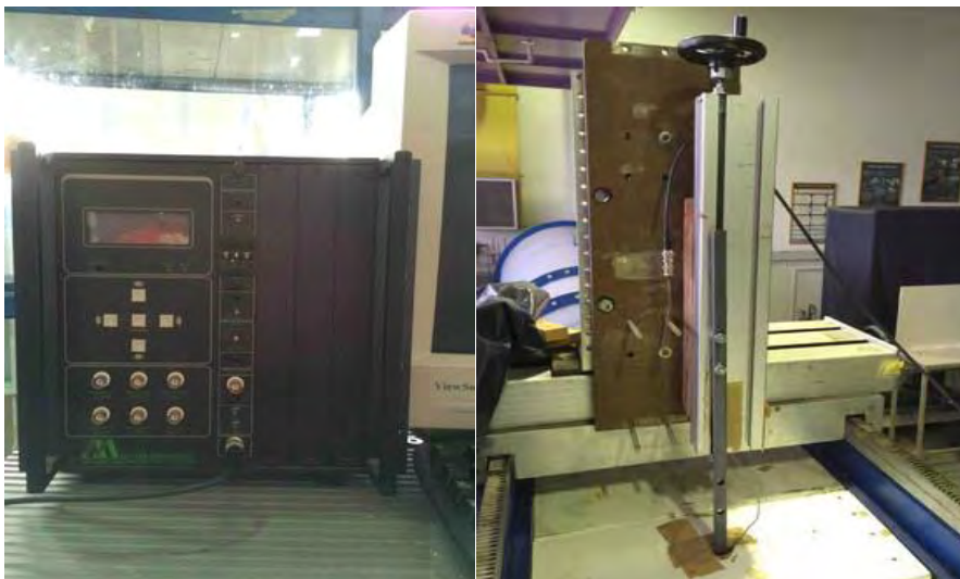
Σχήμα 3.8 Ενισχυτής σήματος του hot wire και μηχανισμός για την κατακόρυφη μετατόπισή του
