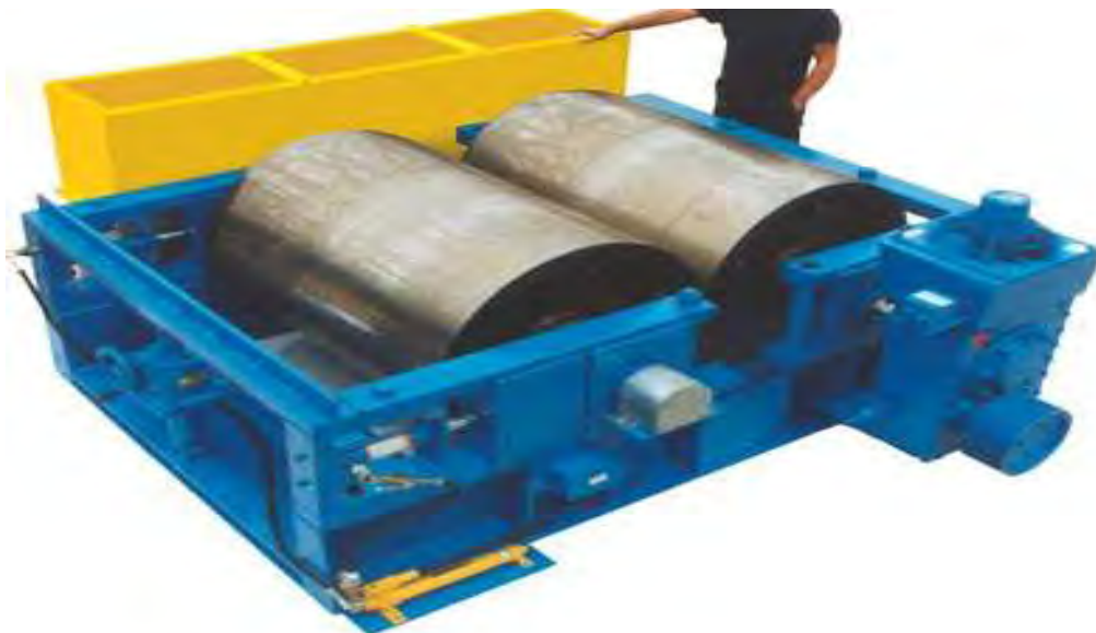
Εικόνα 3-4: Θραυστήρας με λεία ράουλα [27]
