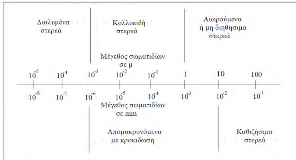
Σχήμα 2.2: Κατάταξη και σειρά μεγέθους των στερεών στα υγρά απόβλητα (ΠΗΓΗ: Βλυσίδης, 2007)
