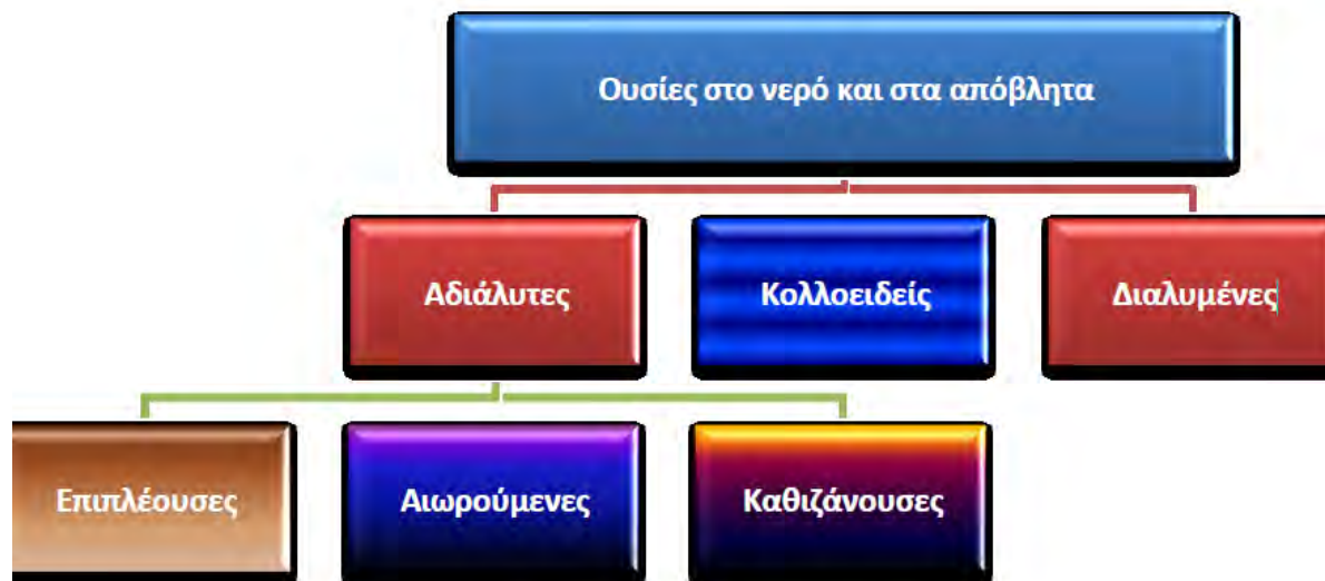
Σχήμα 2.1: Κατηγορίες των στερεών στα υγρά απόβλητα (ΠΗΓΗ: Νταρακάς, 2010)
