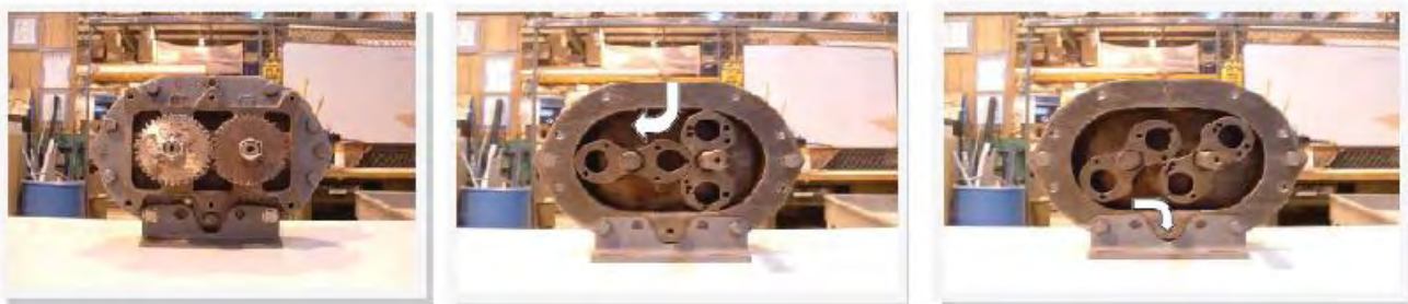
Σχήμα 5.11: Γρανάζια (αριστερά) συγχρονίζονται και δίνουν κίνηση στους λοβούς (αριστερά) για να συμπιέσουν τον αέρα (ΠΗΓΗ: Ohio EPA, http://epa.ohio.gov/Portals/35/compl_assist/Class%20A%20Training%20Manual%20Complete%20Web.pdf )
