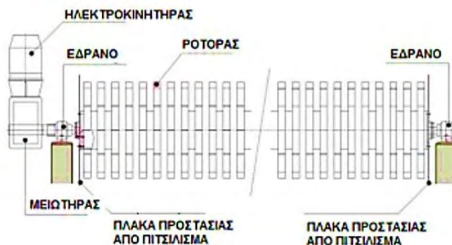
Σχήμα 3.28: Μηχανικά Μέρη Ρότορα (ΠΗΓΗ: ΜΙΧΟΣ Α.Ε.,
