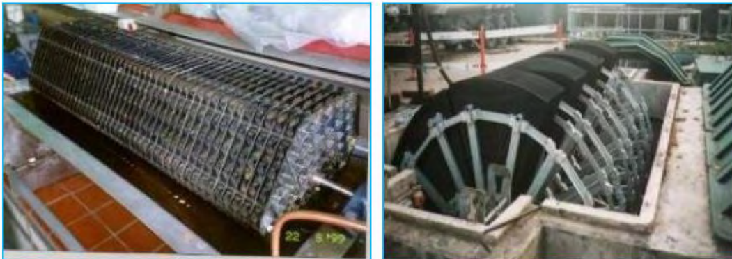
Σχήμα 3.20: Βιολογικοί Δίσκοι (ΠΗΓΗ: Νταρακάς, 2010)
