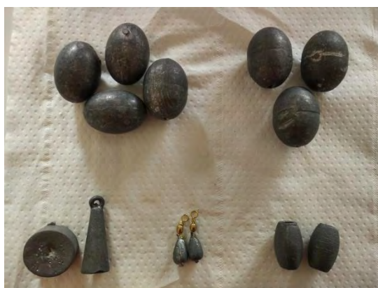
Εικόνα 44: Φωτογραφία με όλα τα είδη μολύβδινων βαριδιών διαφορετικού βάρους που χρησιμοποιήθηκαν για τον προσδιορισμό της αντοχής των ραμμάτων.
