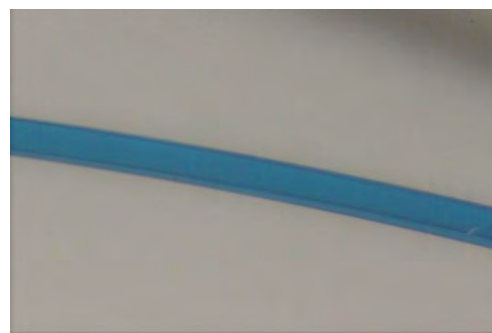
Εικόνα 39: Φωτογραφία στερεοσκοπίου ράμματος Polypropylene, σε μεγέθυνση X40, στο κύριο σώμα του υλικού.
