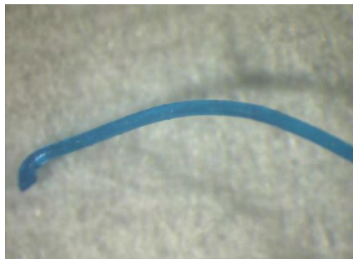
Εικόνα 37: Φωτογραφία στερεοσκοπίου ράμματος Ethicon, σε μεγέθυνση X40 στο σημείο κοπής.
