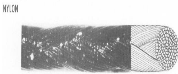
Εικόνα 23: Φωτογραφία και αναπαράσταση της πλεγμένης σύνθετης δομής του ράμματος από νάιλον σε μεγέθυνση X50.
