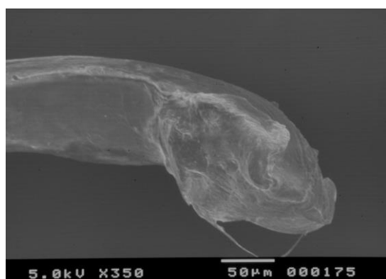
Εικόνες 45, 46: Φωτογραφίες ηλεκτρονικού μικροσκοπίου σάρωσης ράμματος Prolene 6-0 αρχικού μήκους 60cm στην περιοχή αστοχίας.
