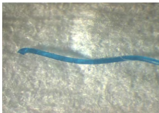
Εικόνα 36: Φωτογραφία στερεοσκοπίου ράμματος Corolene, σε μεγέθυνση X40 στο σημείο κοπής.
