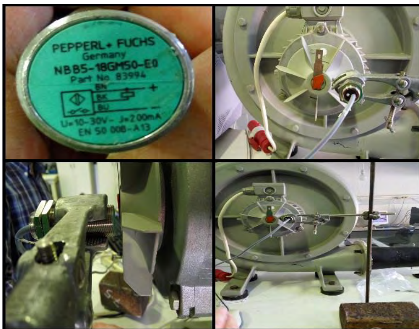
Εικόνα 3.21 : Διάταξη μέτρησης στροφών με χρήση επαγωγικού αισθητήρα.
