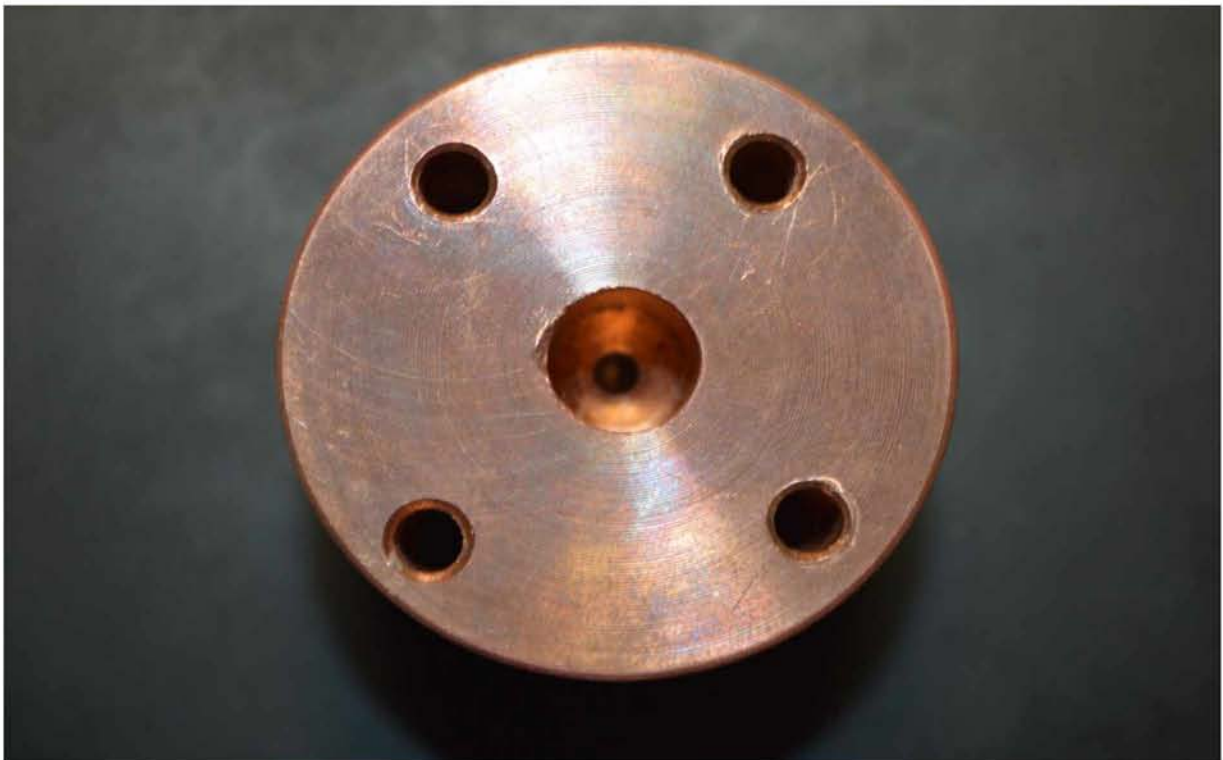
Σχήμα 4.1 Ο πυρήνας από χαλκό με την κεντρική οπή ενθυλάκωσης του soldering iron και τις τέσσερις οπές για τις κοχλιοσυνδέσεις.
