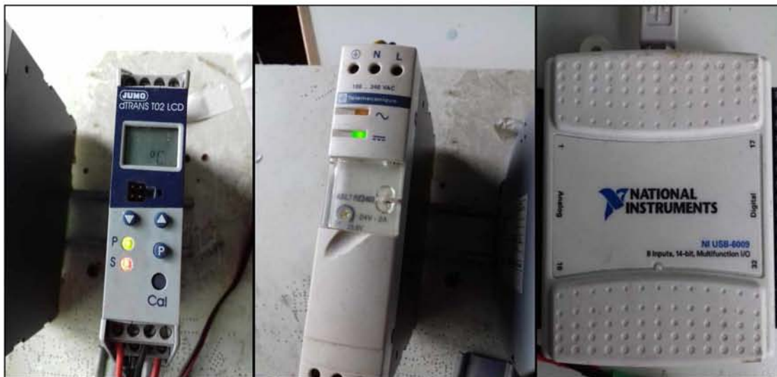
Σχήμα 3.4 Το transmitter Jumo, το τροφοδοτικό Telemechanique και ο μετατροπέας σήματος της National Instruments
