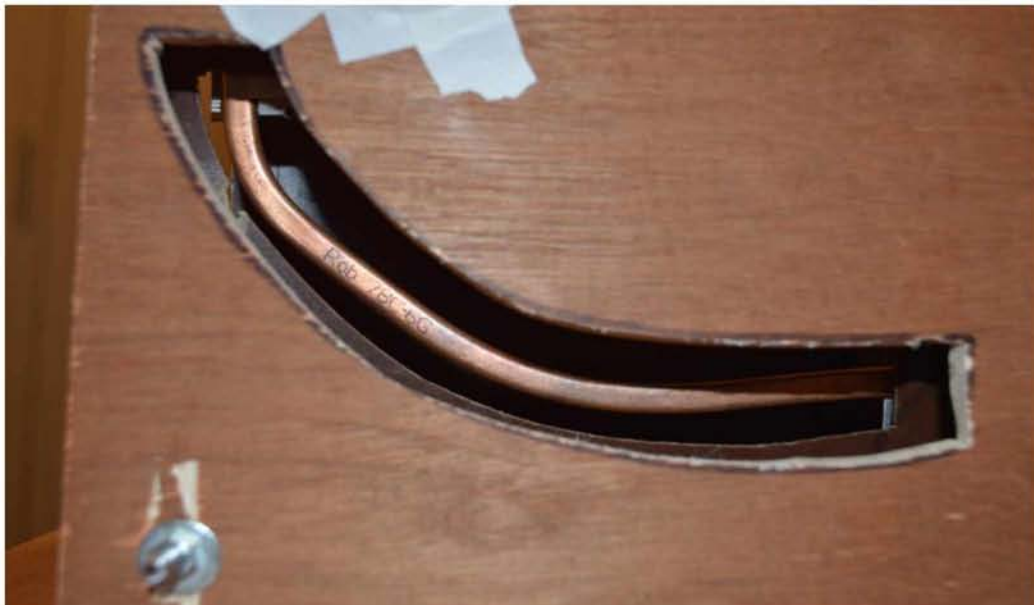
Σχήμα 4.11 Παράθυρο σκόπευσης της κάμερας FLIR στο heat pipe
