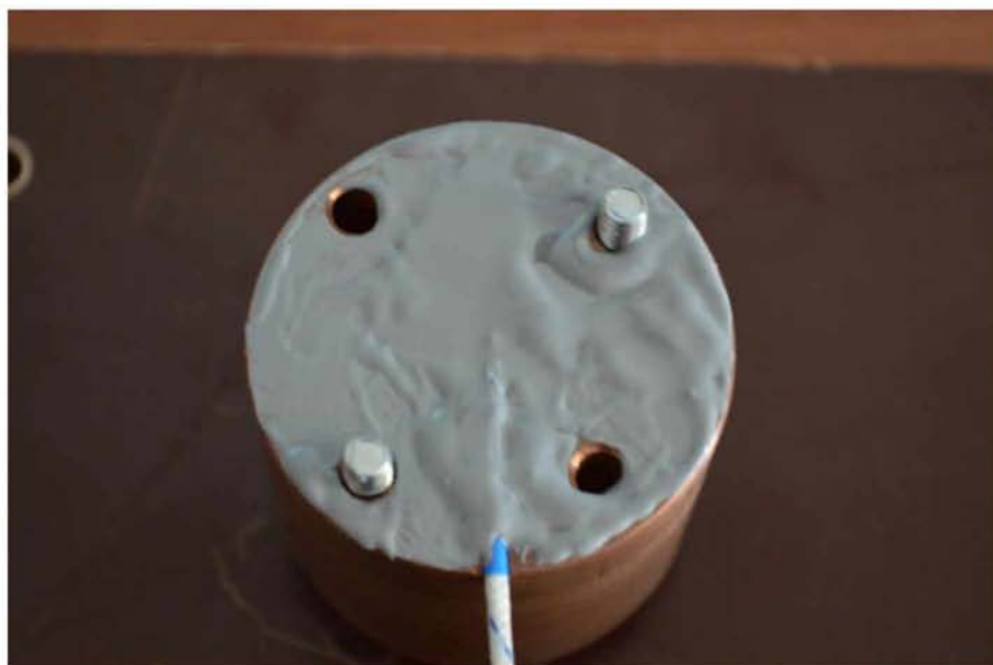
Σχήμα 4.4 Τοποθέτηση θερμό-αγώγιμης πάστας πριν τη συναρμολόγηση
