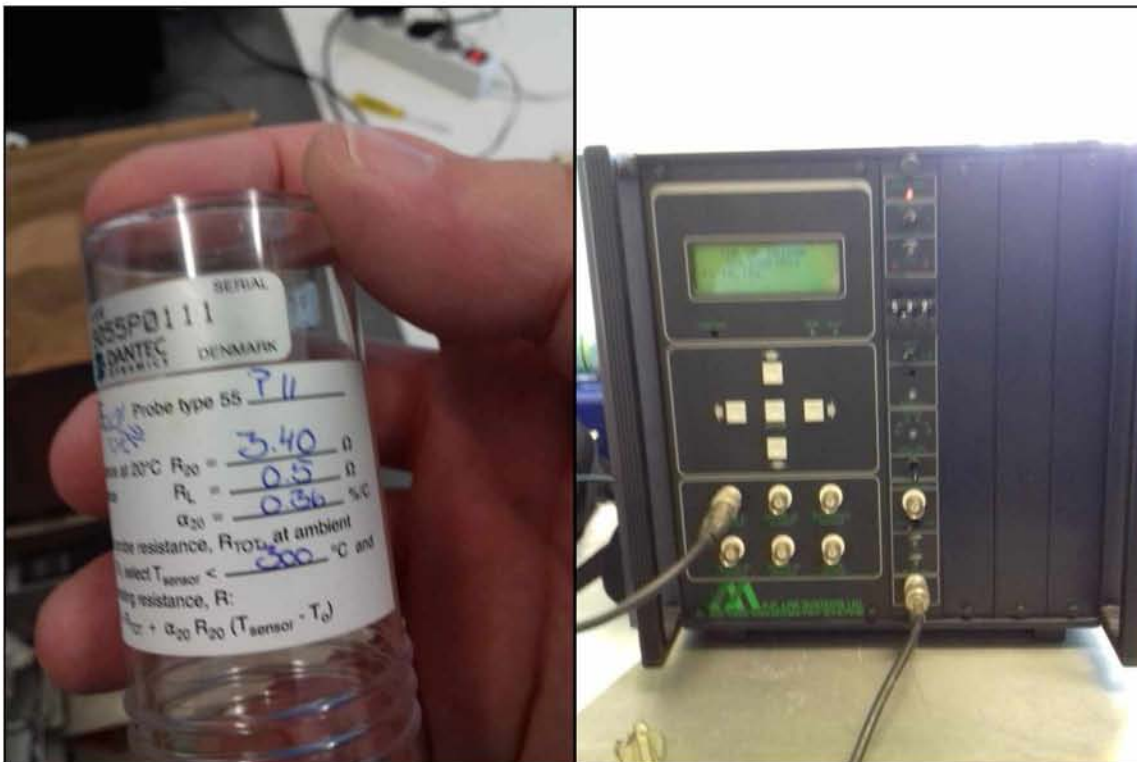
Σχήμα 3.2 Ο αισθητήρας διαμέτρου 5 \mu m και ο ενισχυτής του θερμο-ανεμόμετρου
