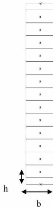
Σχήμα 5.13 Διαχωρισμός της διατομής των πτερυγίων ψύξης σε 14 ορθογώνια
