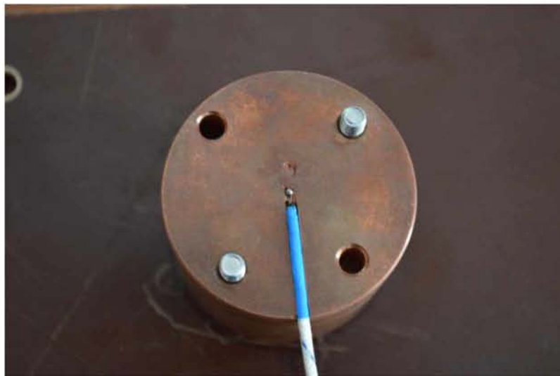
Σχήμα 3.3 Το θερμοστοιχείο στον πυρήνα από χαλκό
