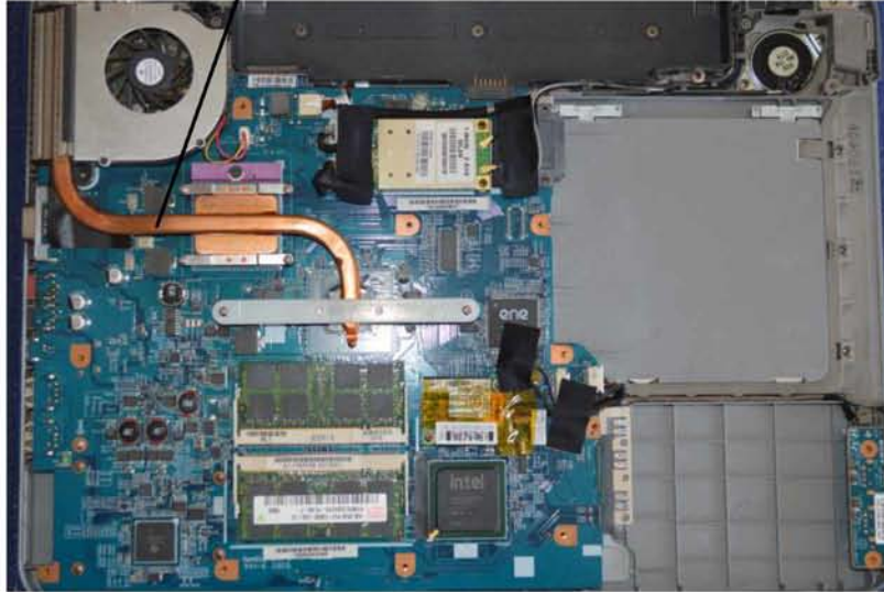
Σχήμα 1.2 Εσωτερικό ενός Laptop
