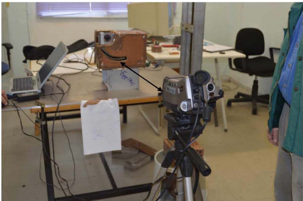
Σχήμα 3.7 Ρύθμιση της οριζόντιας απόστασης κάμερας-συσκευής στο 1,5 m
