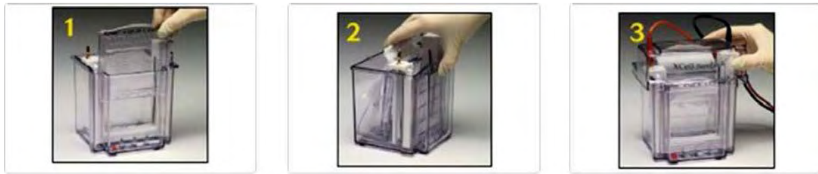
Εικόνα 3.1: Απεικόνιση του τρόπου προετοιμασίας της συσκευής για την ηλεκτροφόρηση των πρωτεϊνικών δειγμάτων [ http://www.lifetechnologies.com/1/1/14473-xcell-surelock-mini-cell-xcell-ii-blot module.html ].
