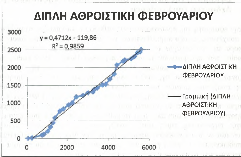
Διάγραμμα 5.5 : Διπλή Αθροιστική Καμπύλη μηνιαίου ύψους βροχής (mm) Φεβρουαρίου (1960 – 1989), όπως προκύπτει από τα δεδομένα του Πίνακα 5.6.
