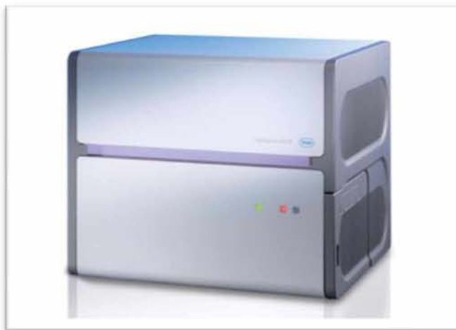
Εικόνα 16 Θερμικός κυκλοποιητής Lightcycler® 480 Instrument II (ROCHE DIAGNOSTICS)
