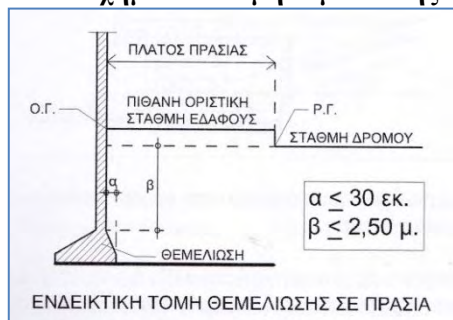
Σχήμα 88: Τομή θεμελίωσης
