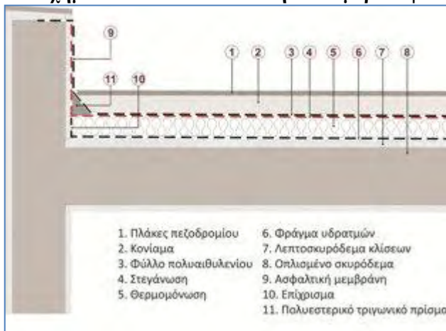
Σχήμα 91: Κατασκευαστική λεπτομέρεια φυτεμένου δώματος
