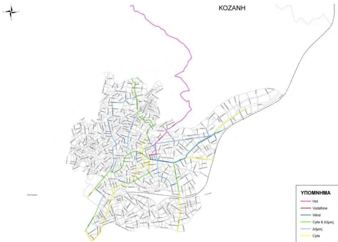
Εικόνα 54: Οδευση του δικτύου οπτικών ινών στη πόλη της Κοζάνης
