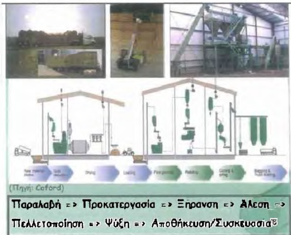
Εικόνα 17: Διαδικασία παραγωγής pellets
