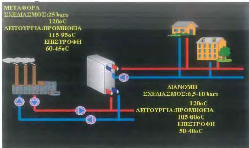
Εικόνα 19: Σύστημα τηλεθέρμανσης στην Δανία
