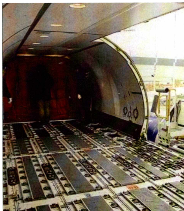
Εικόνα 8 Κύριο κατάστρωμα φόρτωσης με ράουλα
