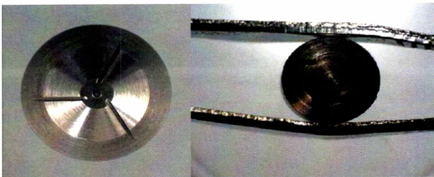
Γράφημα 2.5 Η διαφορετική μορφή των ρήθρων στο εσωτερικό του εκνεφωτή μας οδηγεί σε διαφορετικό είδος κώνου. Αριστερά έχουμε τύπου B ακροφύσιο (της εν λόγω πειραματικής διάταξης) ενώ δεξιά τύπου A.
