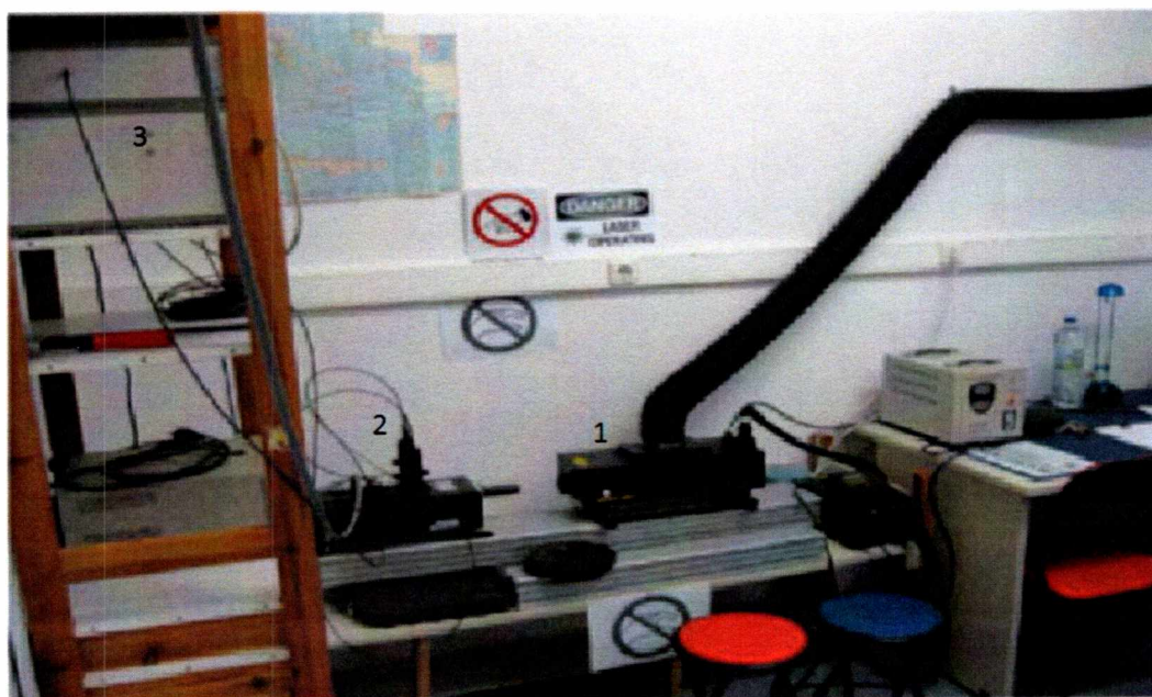
Φωτογραφία 3.12 Συσκευές που εμπλέκονται στη διαδικασία των μετρήσεων. Διακρίνονται : 1. Laser Head, 2. Multicolor Beam Separator και 3. Photo Detector Module.
