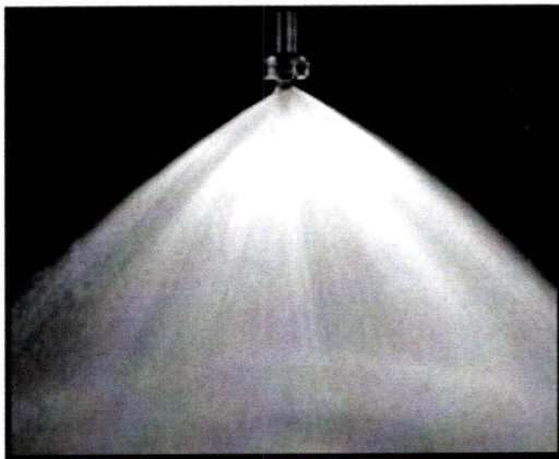
Εικόνα 2.4 Φωτογραφία και σχηματική απεικόνιση πίδακα εγχυτήρα Τύπου W [2] .
