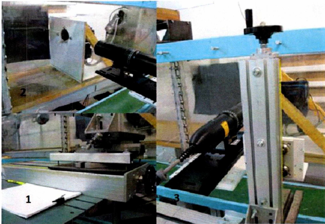
Φωτογραφία 3.4 Ολόκληρη η πειραματική διάταξη. Παρουσιάζονται 1. ο μηχανισμός κίνησης του laser, 2. ο τροποποιημένος καυστήρας και 3. ο Probe.
