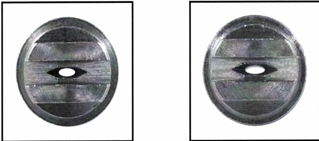
Εικόνα 2.9 Φωτογραφία εγχυτήρα πριν και μετά από χρήση. Η μεταβολή που παρατηρείται στην οπή έχει ως αποτέλεσμα τη δημιουργία μεγαλύτερων σφαιριδίων καυσίμου, ενώ μετρήθηκε αύξηση στην ογκομετρική παροχή της τάξεως του 30%. [2]
