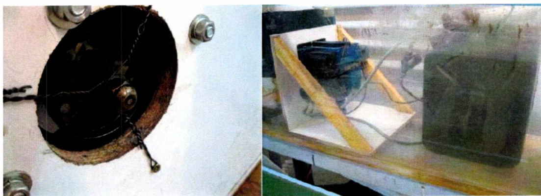
Φωτογραφία 3.15 Στήριξη του ακροφυσίου, το δοχείο καυσίμου και το φίλτρο σε διάταξη στο εσωτερικό της υδροσύραγγας.
