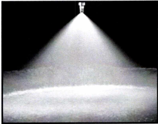
Εικόνα 2.3 Φωτογραφία και σχηματική απεικόνιση πίδακα εγχυτήρα Τύπου B [2] .
