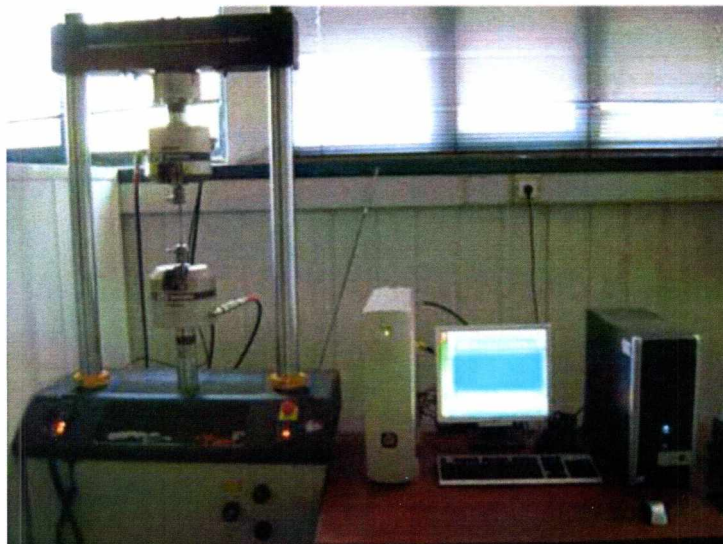
Σχήμα 3.3 - Εικόνα - Διάταξη μηχανής Instron 8801 στο εργαστήριο Υλικών του Πανεπιστημίου Θεσσαλίας
