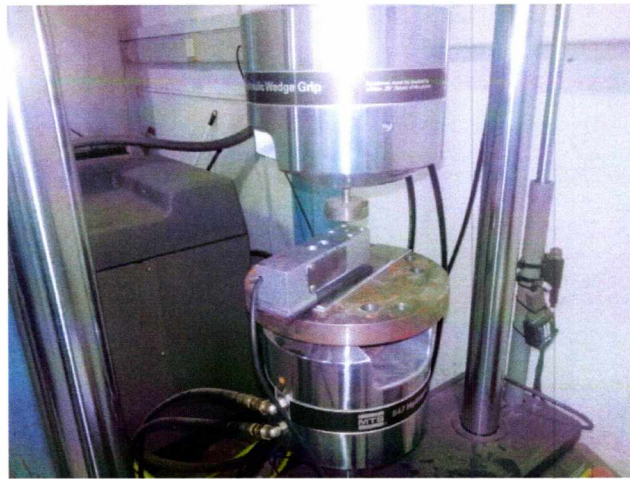
Σχήμα 26: Εικόνα για τον έλεγχο σωστής λειτουργίας δυναμοκυψέλης με χρήση της μηχανής εφελκυσμού.
